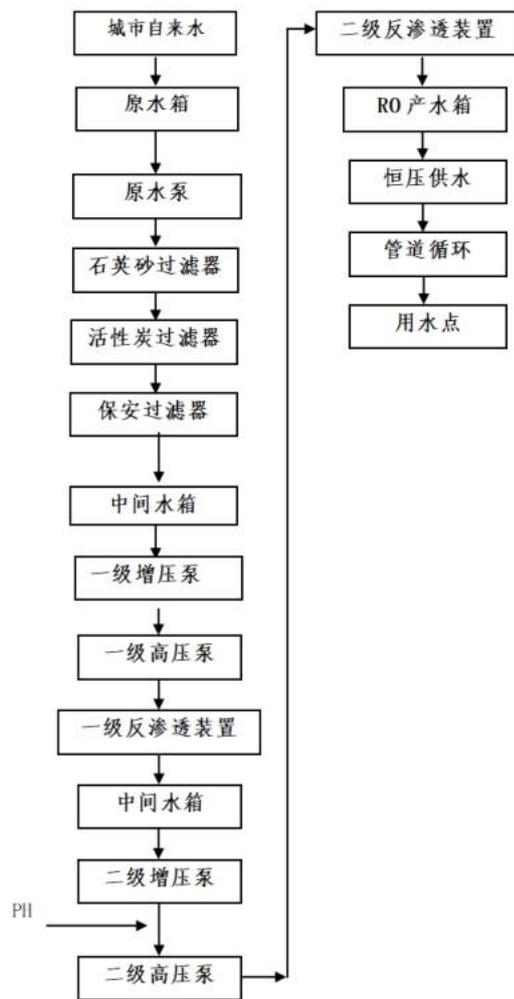
本项目处理水源为自来水，设计进水量约 $>10\text{m}^3/\text{h}$ ，原水水质主要指标如下，根据自耗水、系统清洗维护等情况，产水量约 $6\text{m}^3/\text{h}$ 。变动后，新建一套制水能力为 $6\text{t}/\text{h}$ 、制水率75%的软水系统能满足企业生产用水需要。
